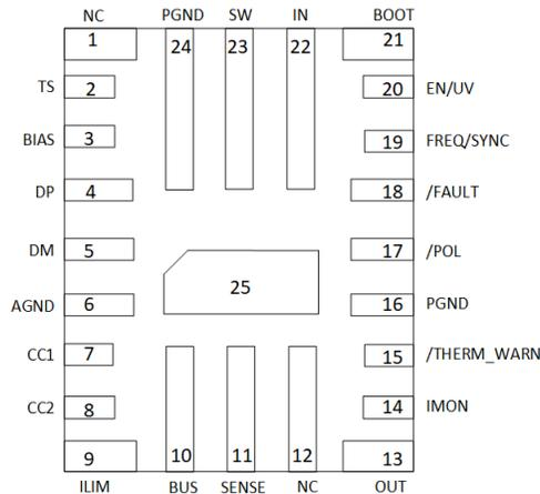
**Figure 7-1. TPS2585x-Q1 RPQ Package 25-Pin (QFN) Top View**
