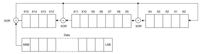
Figure 8-10. CCITT-16 CRC Module Block Diagram
