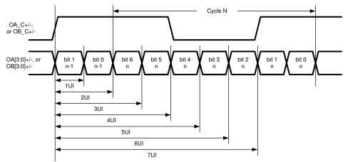
Figure 7-9. LVDS Serial Bit Positions
