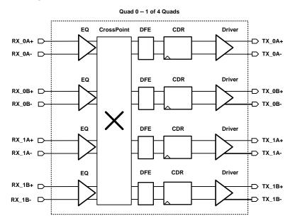
Figure 1. DS125DF1610 Simplified Cross Point Diagram
