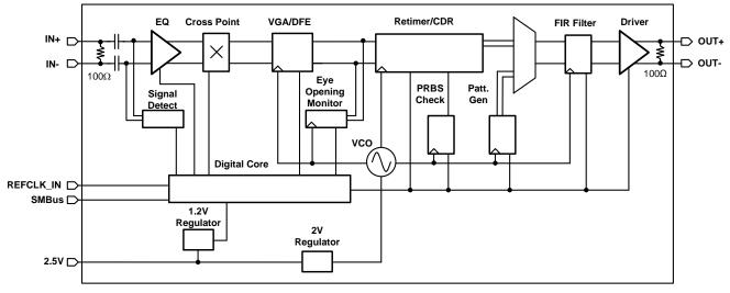
Figure 2. DS125DF1610 Simplified Data Path Diagram
