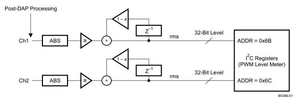
Figure 46. PWM Level Meter Structure
