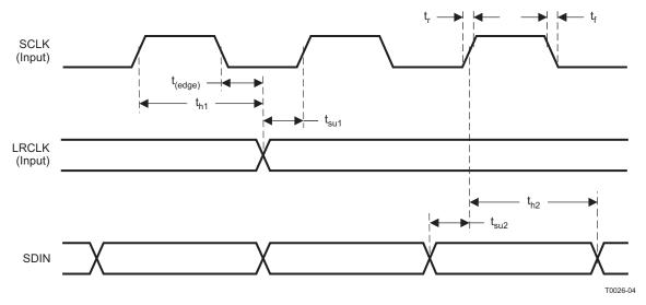
Figure 1. Slave-Mode Serial Data-Interface Timing
