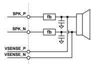
Figure 24. V-Sense Connections
