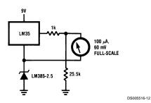
FIGURE 12. Fahrenheit ThermometerExpanded Scale
