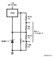
FIGURE 10. Fahrenheit Thermometer
